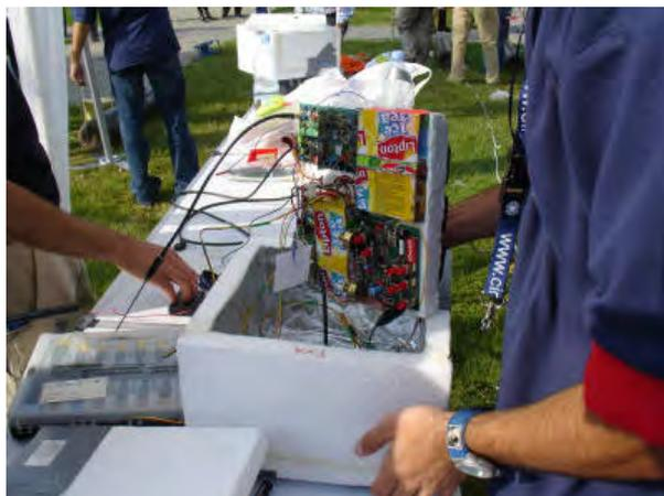
A preparação final dos *payloads* do CineISAT III consistiu num teste final de funcionamento de todo o sistema, após o mesmo ter estado em exposição durante a feira Endiel, o correcto alinhamento das 3 câmaras de vídeo a bordo do balão, a colocação de todas as antenas e a substituição dos sistemas de energia por novos modelos, preparados para o voo. O teste final efectuado antes do lançamento decorreram com sucesso.
