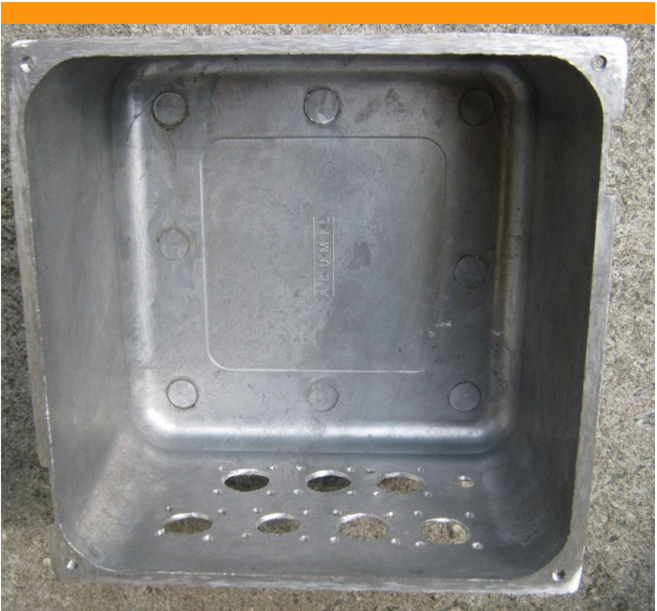
Caixa de Alumínio após a furação
